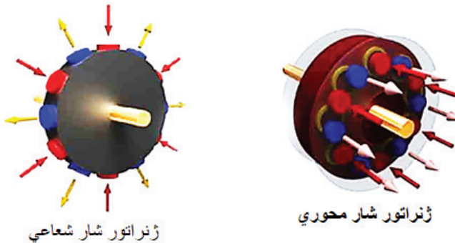
شکل ۲۰. انواع ژنراتورهای الکتریکی از نظر جهت شار مغناطیسی
